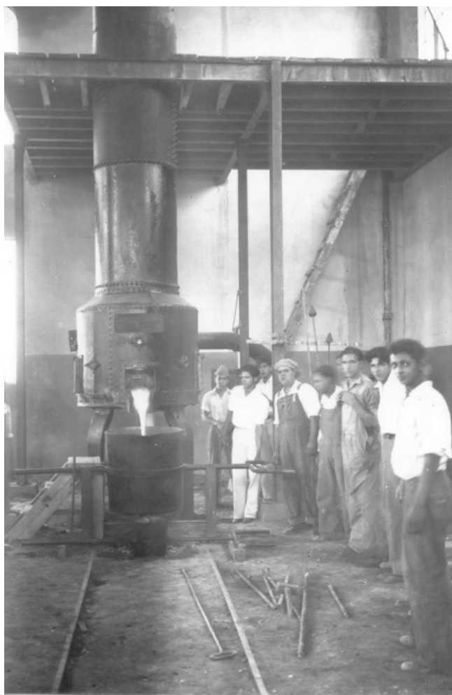
Horno de fundición fabricado por alumnos y profesores, y puesto en función en junio de 1933.
